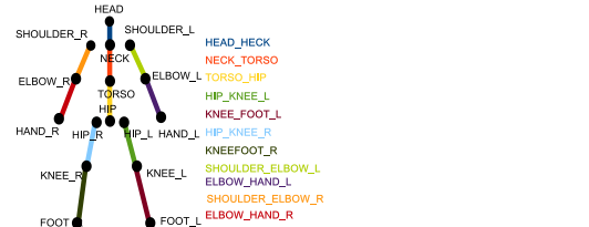
図 2: Kinect センサで取得する関節点とリンク
