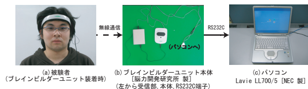
図1: 情動計測実験システムの構成
